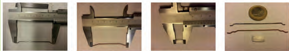
Figure 1 - (a) Steel fibres 3D; (b) Steel fibres 5D; (c) Polypropylene fibres; (d) Fibres used.
